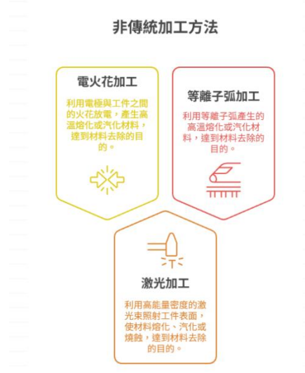
圖 5 不同非傳統加工法原理之比較
